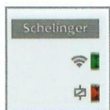
kontrolka sygnalizująca status połączenia
