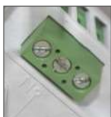
podłączenie 3-przewodowe (L, N, LO)
